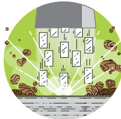
Beim Aufprall auf die Oberfläche sublimiert das Trockeneis, was zu kleinen CO<sub>2</sub>-Explosionen führt und die Verschmutzung abträgt.
