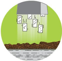
Beschleunigt durch Druckluft, bewegt sich Trockeneis mit Überschallgeschwindigkeit durch die Düse.
