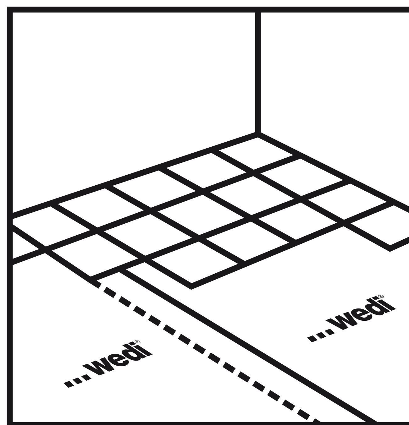
㉒ Nach Erhärtung des Dünnbettmörtels kann der Belag verlegt werden.
