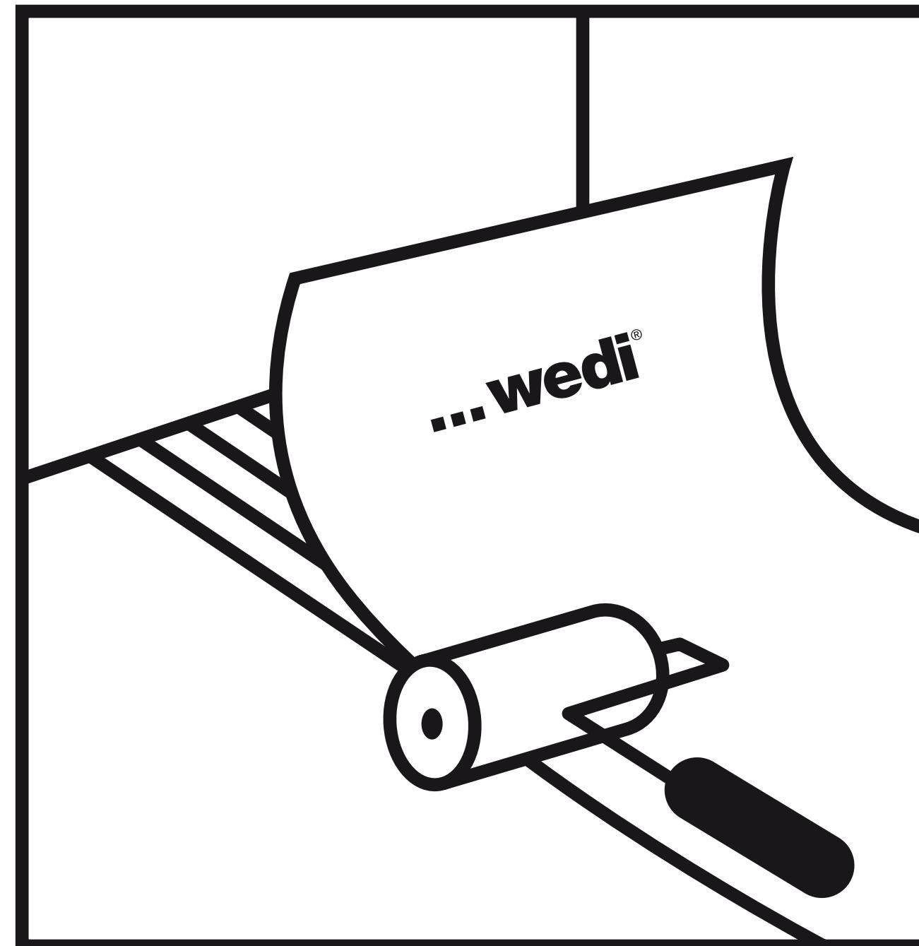
⑬ Die Stöße der Bahnen müssen ca. 5-10 cm überlappen. Zementäre Dichtschlämme (wedi 520) auf überlappenden Bereich aufbringen.
