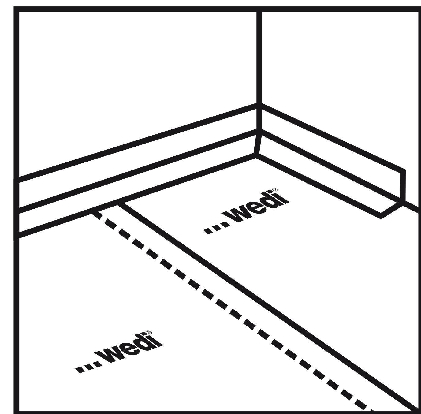
⑲ Eckfugen und Bodenanschlüsse mit wedi Dichtband und zementärer Dichtschlämme (wedi 520) abdichten. Dichtband mittig auf Stoß anbringen.
