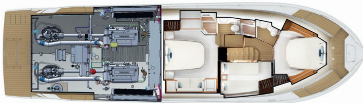
Il layout degli interni prevede tre cabine e due bagni. La suite armatoriale è a centro barca e sfrutta l'intero baglio massimo dello scafo. Oltre alla tradizionale cabina Vip di prua c'è un terzo locale notte con letti separati.
