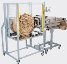
Il **Coiler** è una soluzione complementare progettata per essere utilizzata in combinazione con il **Packmaster™ Pro** al fine di automatizzare il processo di produzione di larghe quantità di solide ed efficienti chiocciole di carta.
