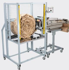
Le **Coiler** est une solution destinée à être utilisée en conjonction avec le système Packmaster™ Pro Fanfold. Il permet la production automatique d'escargots de papier.
