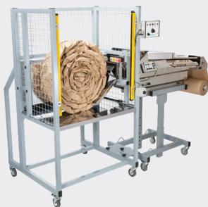
La **Coiler** è una soluzione complementare progettata per essere utilizzata in combinazione con il **Packmaster™ Pro Fanfold** al fine di automatizzare il processo di produzione di larghe quantità di solide ed efficienti chiocciole di carta.
