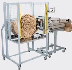
Der **Coiler** ist eine anschraubbare Lösung, die in Verbindung mit dem Packmaster™ Pro System verwendet wird, um den Prozess der Produktion einheitlich großer Mengen stabiler Papier-Coils zu automatisieren.
