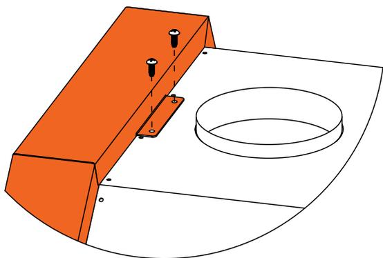
9. Réinstallez le collier de cheminée sur le dessus du four avec 4 vis, puis installez le tube de cheminée.
