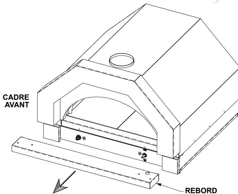
6. Retirez le bouton étincelant du module d'allumage et la batterie, ainsi que les 2 contre-écrous illustrés ci-dessous. Retirez ensuite le panneau de commande. **PRENEZ UNE PRÉCAUTION EXTRÊME AVEC LES CONTRE-ÉCROUS POUR ÉVITER DE POUSSER LE MODULE D'ALLUMAGE À ÉTINCELLES À L'INTÉRIEUR DU FOUR.** Réinstallez temporairement et serrez à la main le contre-écrou gauche pour réduire le risque de pousser le module d'allumage à l'intérieur de l'unité.
