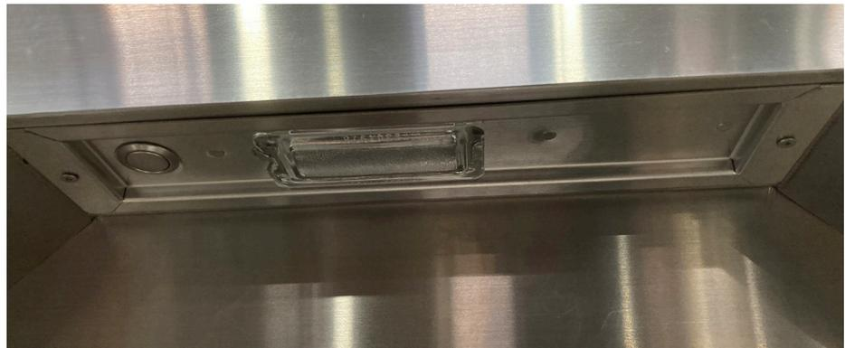
Si la lumière ne fonctionne pas, vérifiez que les connexions de l'ampoule sont bien serrées (minuscules vis de chaque côté du support d'ampoule en céramique), ou remplacez l'ampoule elle-même par une nouvelle ampoule halogène G4 «Bi-pin» 20W. Vous devez desserrer les vis pour remplacer l'ampoule.
