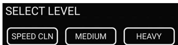
3. Une fois sélectionné, l'écran affiche «SELF CLEAN» et le niveau de nettoyage sélectionné (SPD, MED ou HVY). La porte se verrouille, l'icône de verrouillage et le temps restant s'affichent. La cavité du four atteindra une température d'environ 825°F [440°C].
