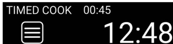
7. Une fois que TIMED COOK (cuisson minutée) est terminée, une alarme sonore retentira au total 3 fois à intervalles d'une minute, ou jusqu'à ce que l'utilisateur annule l'alarme et soit invité à mettre les deux boutons de commande sur «OFF».
