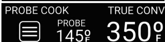
5. Une fois que la Cuisson avec Sonde a atteint la température sélectionnée, les éléments chauffants s'éteignent. Une alarme sonore retentira au total 3 fois à des intervalles d'une minute, ou jusqu'à ce que l'utilisateur annule l'alarme et soit invité à tourner les deux boutons de commande sur « OFF ».
