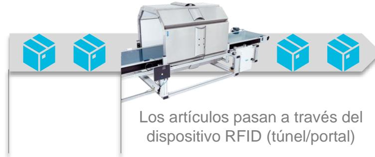
Los artículos pasan a través del dispositivo RFID (túnel/portal)
