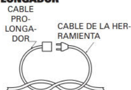
FIGURA 1 MÉTODO PARA ASEGURAR EL CABLE PRO- LONGADOR
