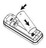
**Paso 3:** Inserte una batería nueva modelo 26650 de 3.6 V, 5000 mAh en la dirección correcta según se indica.
