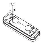
**Étape 1 :** Desserrer les vis à l'arrière du bloc-pile.
