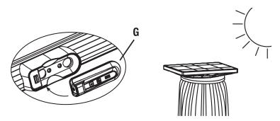
Étape 6 : Retirer la batterie (G) de la boîte d'accessoires. Placer la batterie dans boîtier de batterie situé sur le bras de la poignée coulissante. Charger la batterie en exposant le panneau solaire à la lumière du soleil pendant 8 heures avant la première utilisation.
