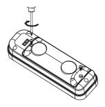
**Paso 5:** Reemplace la cubierta y ajuste los tornillos.
