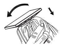
Paso 5: Coloque el panel solar en la parte superior de la sombrilla e inserte el enchufe y el cable a través del orificio de la parte superior. Gire el panel solar hacia la derecha sin apretar demasiado.
