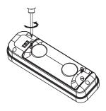
**Paso 1:** Afloje los tornillos ubicados en la parte trasera de la unidad de batería.
