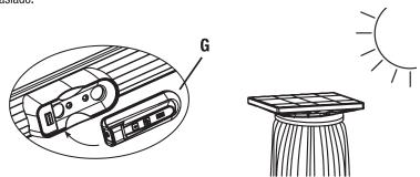
Paso 6: Retire la batería de la caja de accesorios. Poner la batería en el alojamiento de la batería ubicado en el brazo del mango deslizante. Coloque la sombrilla solar en el exterior, en la luz directa del sol para cargar el panel solar durante 8 horas antes del primer uso.
