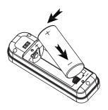
**Étape 3 : I**nsérer la nouve**ll**e pile – modèle 26650 de 3,6 V, 5000 mAh – dans le sens indiqué.
