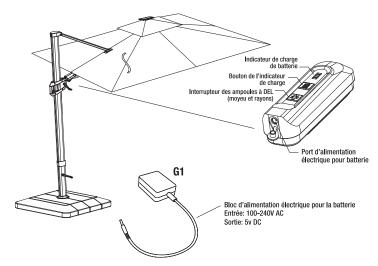
Appuyer une première fois sur l'interrupteur pour allumer les ampoules intégrées au moyeu, une deuxième et une troisième fois pour ajuster la luminosité, une quatrième fois pour allumer les ampoules intégrées aux rayons et éteindre celles intégrées au moyeu, une cinquième fois pour allumer toutes les ampoules, une sixième fois pour régler une luminosité moyenne, une septième fois pour régler une luminosité maximale et une huitième fois pour éteindre toutes les ampoules.
