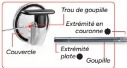
1. Insérer un tournevis dans le trou de goupille à gauche du levier. Pousser contre l'extrémité plate de la goupille pour la retirer et détacher le levier du couvercle. Mettre la goupille de côté en faisant attention de ne pas la perdre.
