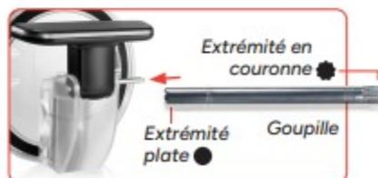
8. Maintenir l'extrémité en couronne de la goupille, insérer l'extrémité plate de la goupille dans le trou de goupille sur le côté droit du levier, puis pousser la goupille pour la faire passer à travers.
