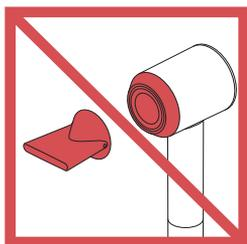
La salida de aire, el anillo metálico, los accesorios y el área sombreada en rojo pueden calentarse durante el uso. Antes de manipularlos, déjelos enfriar.
