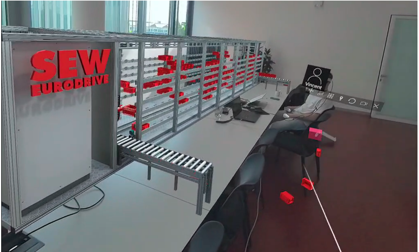
産業用デジタルツイン - マルチユーザー AR セッションで自動化コントローラーに接続されています。画像提供: SEW-Eurodrive および realvirtual.io
