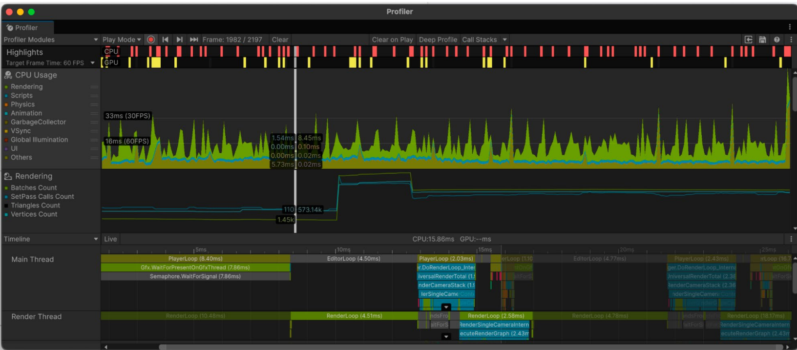
CPU Usage 모듈의 Timeline 뷰: Main Thread 및 Render Thread 마커 세부 정보를 표시
