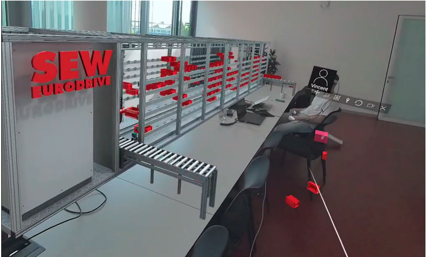
멀티뷰어 AR 세션에서 자동화 컨트롤러에 연결된 산업용 디지털 트윈. 이미지 제공: SEW-Eurodrive 및 Realvirtual.io
