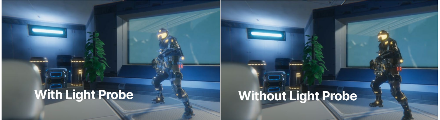
동적 오브젝트 렌더링 시 라이트 프로브를 사용한 효과: 왼쪽은 라이트 프로브 사용, 오른쪽은 미사용
