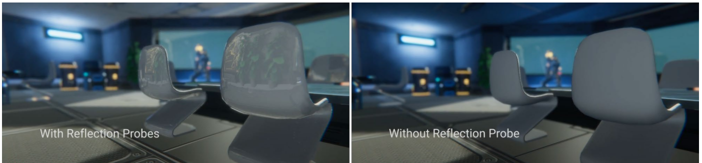
매끄러운 표면에 반사 프로브를 사용한 효과: 왼쪽은 반사 프로브 사용, 오른쪽은 미사용
