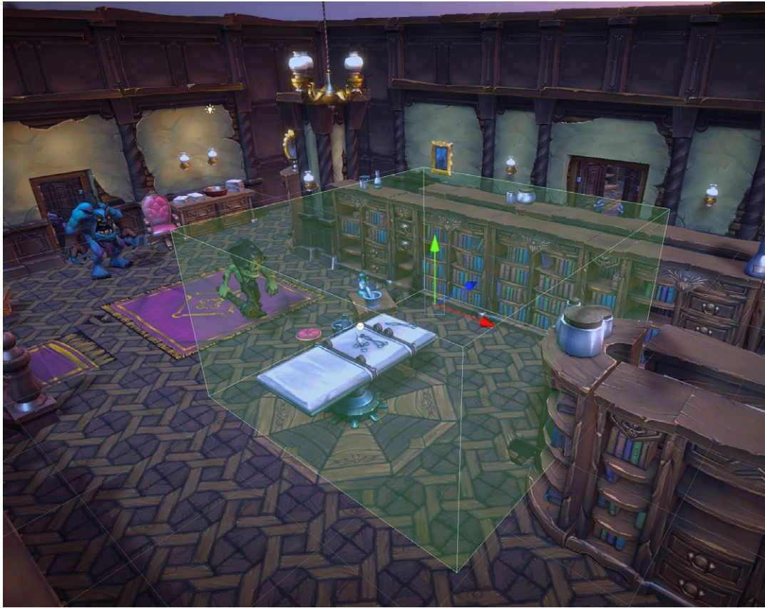
연결된 Box Collider 컴포넌트를 사용하여 박스 볼륨의 위치를 지정하고 크기를 조절
