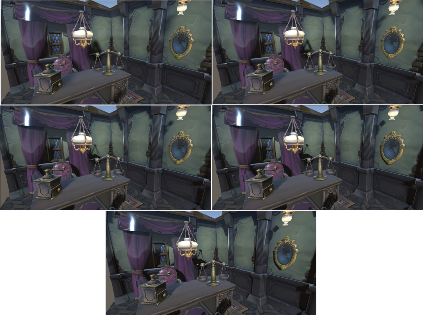
메인 광원의 그림자 해상도 설정: 왼쪽 상단 이미지는 256, 오른쪽 상단 이미지는 512, 왼쪽 가운데 이미지는 1024, 오른쪽 가운데 이미지는 2048, 하단 이미지는 4096으로 해상도 설정
