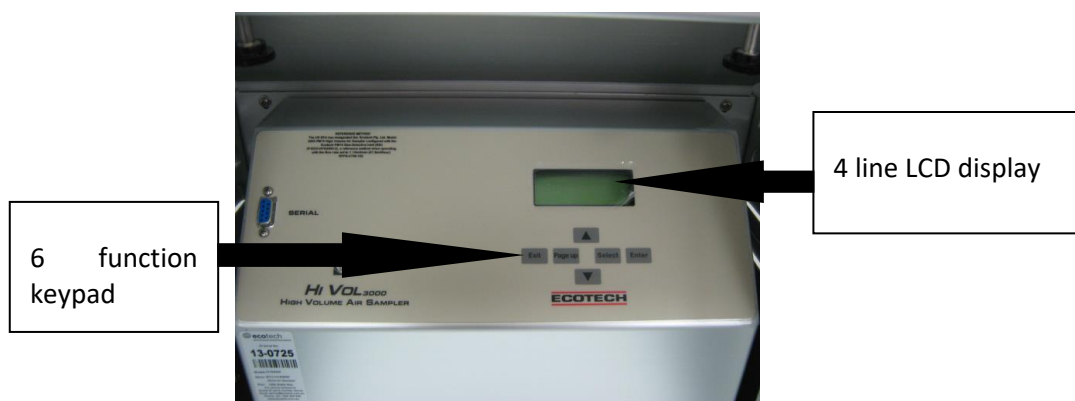
Figure 13 – HiVol 3000 control panel
