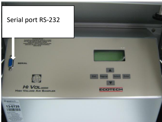
Figure 35 – HiVol serial port (RS-232)
