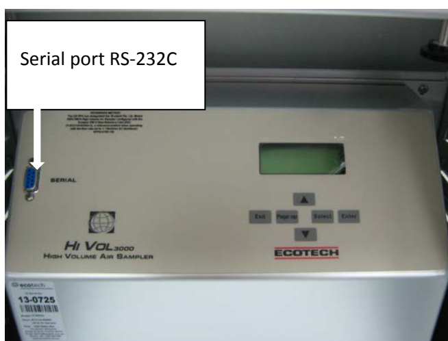
Figure 17– HiVol serial port (RS-232C)
