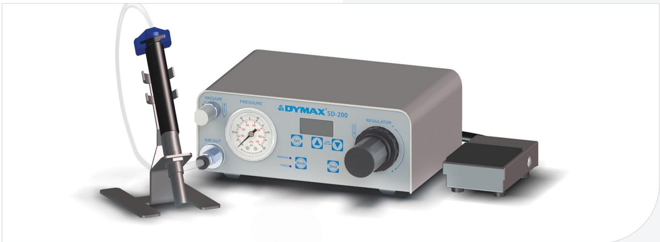
El dispensador digital de jeringas SD-200 dispensa con precisión materiales de baja a alta viscosidad de una jeringa. Los operadores pueden rápida y fácilmente configurar el sistema para el tamaño de depósito requerido con el control digital de tiempo y medidor de presión ajustable. El SD-200 es ideal para usar como una estación de trabajo del operador y también se puede integrar en un proceso automatizado conectando una señal externa a la entrada del sistema.
