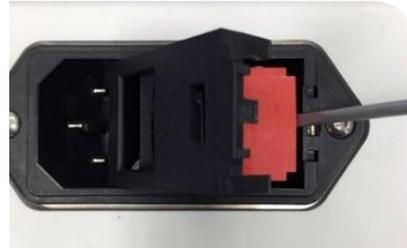
3. Nehmen Sie die Sicherungshalterung heraus. (Abbildung 51). Die Sicherungshalterung ist orientierungshalber beschriftet.
