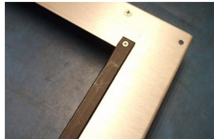
Figure 35. Installation des vis M3 x 6 mm dans la bande anti-usure
