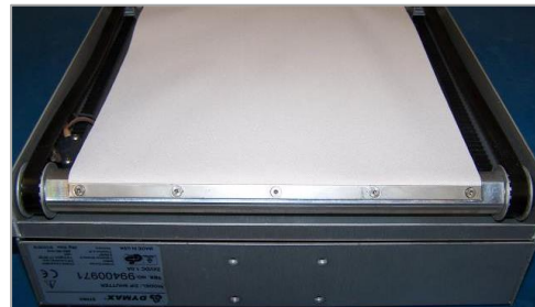
Figure 25. Module rideau intérieur (ici : rideau en kevlar)
