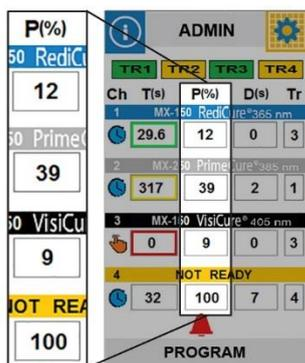
**Emitterleistung (DB) (1-4):** Die Aushärtungsleistung wird als Prozentsatz in der dritten Spalte unter der Überschrift P (%) angezeigt. Wenn Sie auf dieses Anzeigefeld drücken, schaltet das Gerät auf die Ansicht des Leistungspegels um. Die Leistung kann von 1-100% in 1-Prozent-Schritten eingestellt werden.
