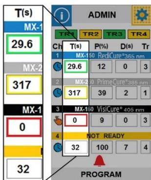
**Bestrahlungsdauer (DB) (1-4):** Die Bestrahlungsdauer wird für jeden Kanal in der zweiten Spalte unter der Überschrift T(s) angezeigt. In der zeitgesteuerten Betriebsart wird die Dauer durch Betätigung der Schaltfläche T(s) eingegeben. Hierbei erscheint dann ein numerisches Tastenfeld für die Dateneingabe. Der Eingabebereich liegt bei 0,1 - 999 Sekunden. Zwischen 0,1 und 30 Sekunden erfolgt die Anpassung in 0,1-Sekunden-Schritten und zwischen 30 und 999 Sekunden in 1-Sekunden-Schritten.
