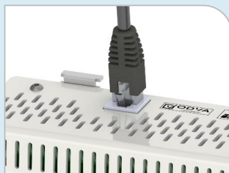
Abbildung 10. Geschirmtes Ethernet-Kabel in Anschluss RJ45
