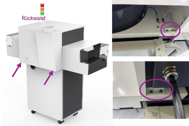
Abbildung 13. Lösen Sie die Schrauben unter der Rückwand, an der das untere Gehäuse befestigt ist
