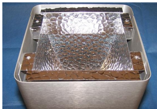
Figura 5. Alloggiamento del riflettore, piastra di spessoramento rimossa
