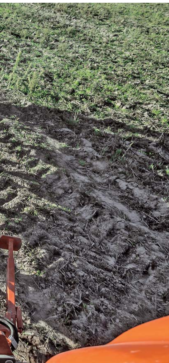
Les perches profilés suppriment les risques de bourrage en présence de résidus
