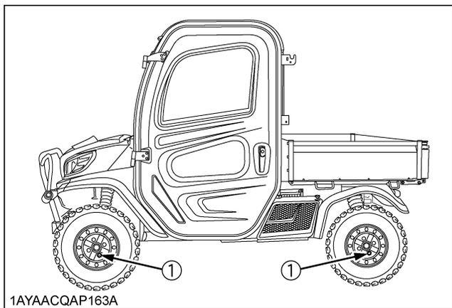
(1) Couple de serrage (boulons et écrous)
