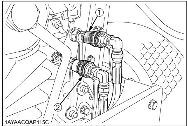
(1) Sortie hydraulique (si équipé) [jaune]
