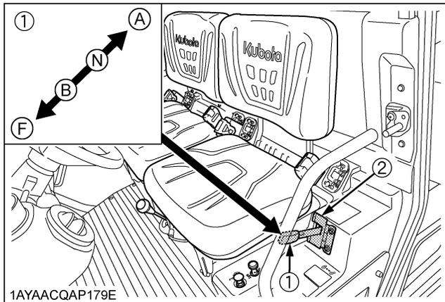
(1) Levier de commande du cylindre de levage hydraulique
