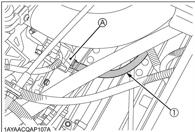
(1) Réservoir d'huile → Pompe hydraulique
