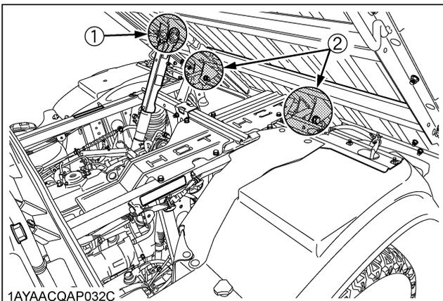
(1) Pivots, cylindre de relevage de la benne (Graisseur)
