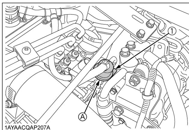
(1) Levier de la pompe à carburant (A) Pompe d'injection du carburant
