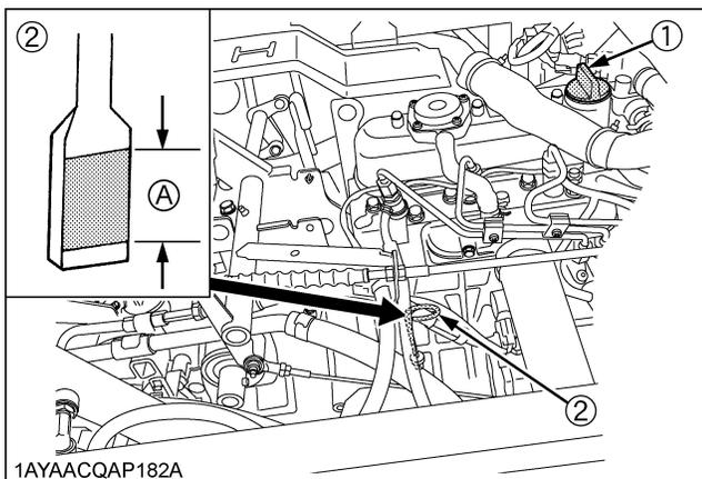
(1) Bouchon de remplissage (A) Niveau d'huile acceptable
