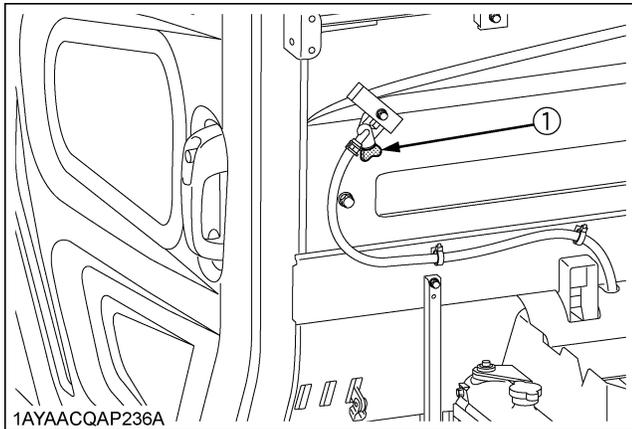
(1) Purgeur du liquide de refroidissement du moteur
