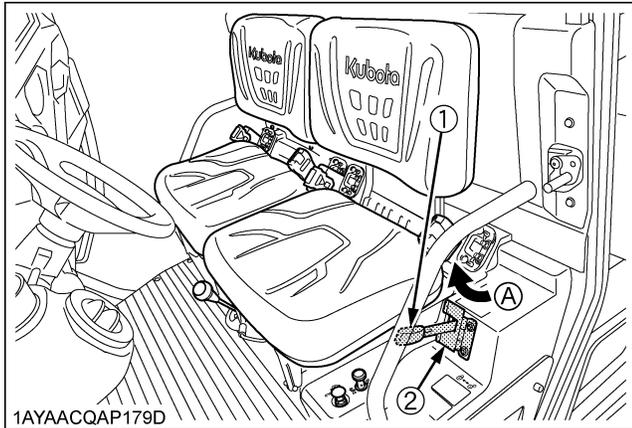
(1) Levier de commande du cylindre de relevage hydraulique (si équipé) ou Levier de distributeur hydraulique (A) "VERROUILLER"
