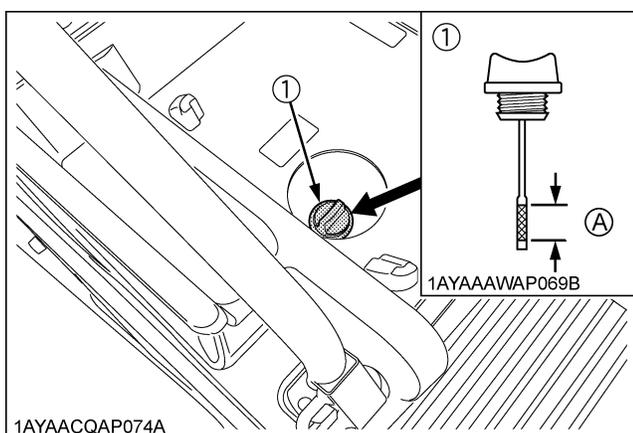
(1) Bouchon de remplissage avec jauge de niveau
