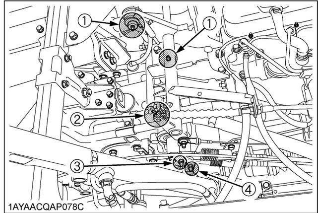
(1) Tringlerie VHT (Graisseur)
