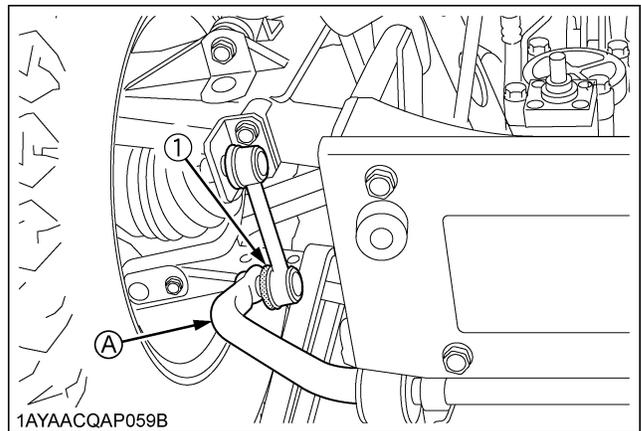
(1) Caoutchoucs des cardans arrière (A) Stabilisateur arrière
