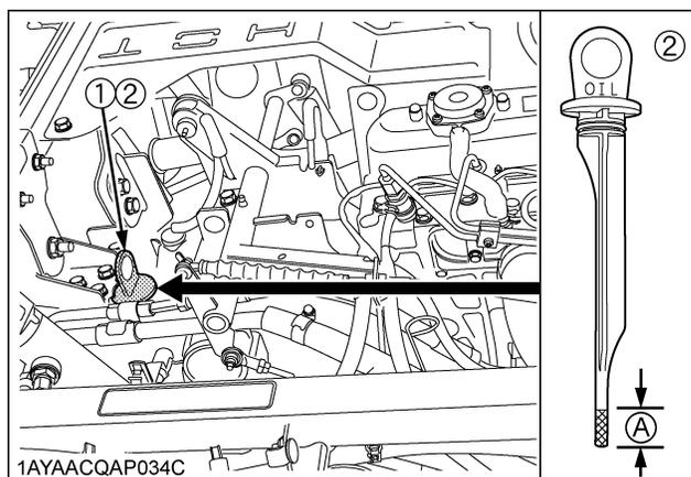
(1) Bouchon de remplissage (A) Niveau d'huile acceptable
