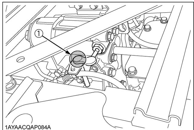
(1) Liaison déchargement (graisse de type à vaporiser)
