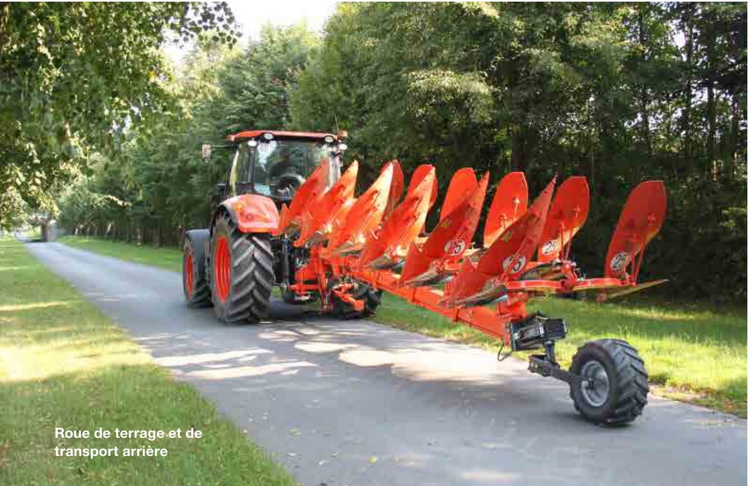
Roue de terrage et de transport arrière
