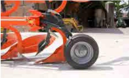
**Roue de contrôle arrière, télescopique**
