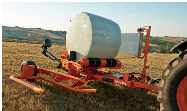
La table tournante avec deux rouleaux entraînés est conçue pour assurer une haute stabilité des balles et une rotation uniforme et constante.
