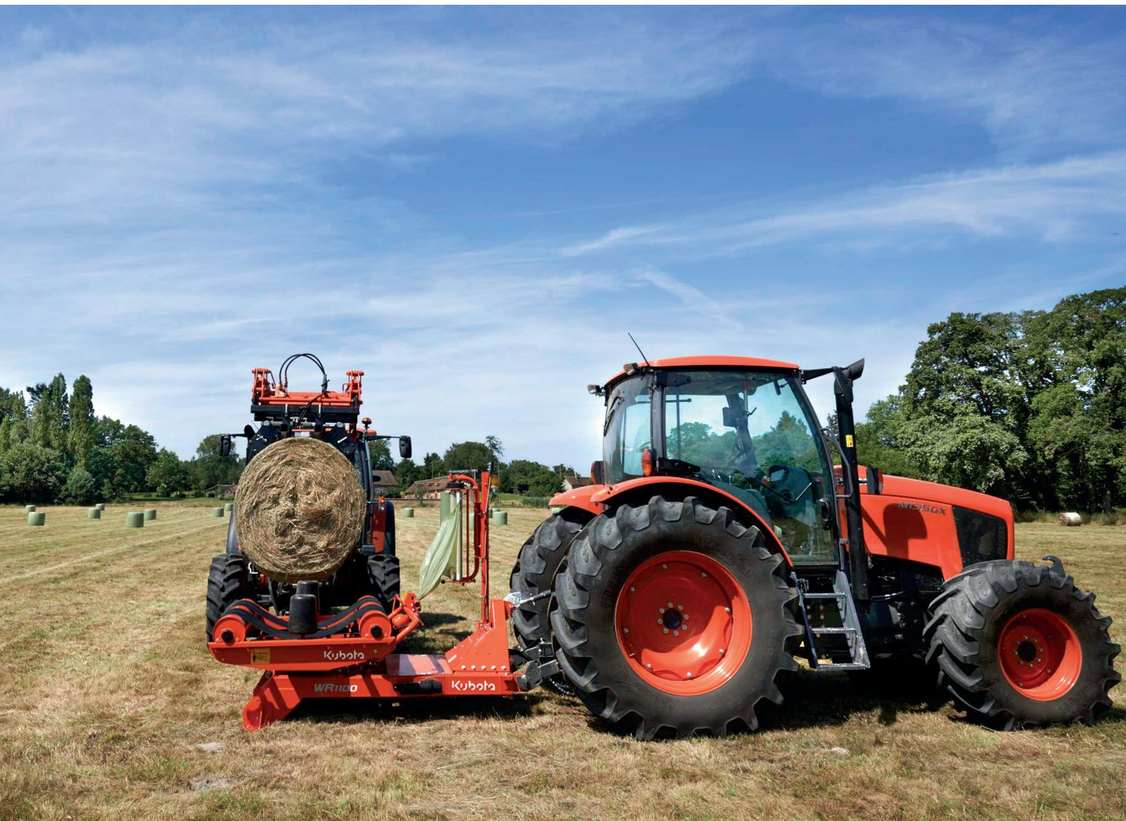
La version WR1100C de Kubota dotée d'un boîtier de commande et d'une télécommande à radiofréquence offre un fonctionnement entièrement automatique.
