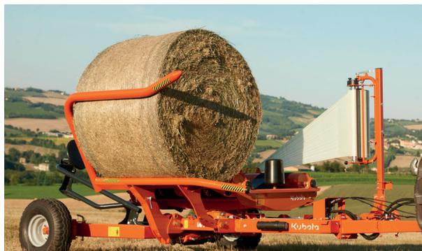
Le bras de chargement à commande hydraulique et faible hauteur de chargement permet un transfert rapide de la balle du bras à la table tournante.
