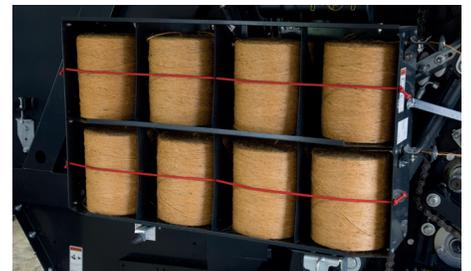
Capacité de stockage de huit bobines de ficelle.
