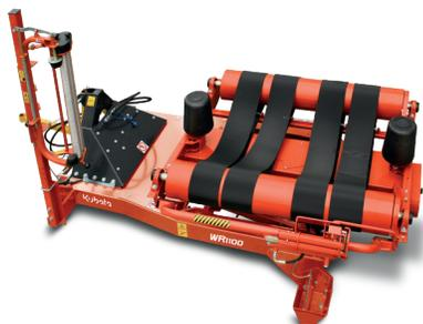
Des compteurs de balles multiples sont inclus de série et un capteur de rupture de pellicule est offert en option.
