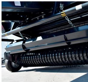
Ramasseur de 86 po de large à ratissage propre avec chenilles à double came, 5 barres porte-dents et rouleau tasse-andain.
