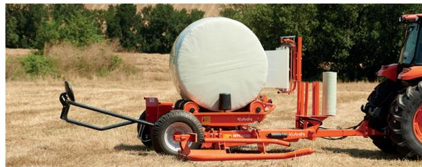
Le bras de chargement réglable avec butée arrière et tube de soutien interne permet de saisir et de charger la balle en mouvement.
