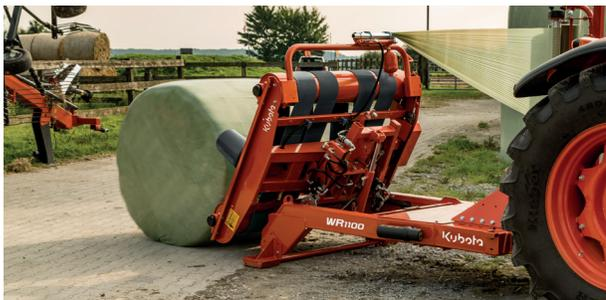
Compatible avec les presses à balles rondes jusqu'à 2 200 lb (1 000 kg).
