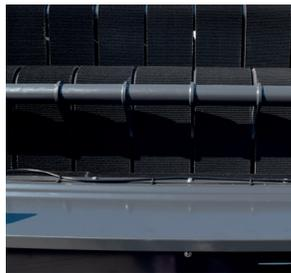
Courroies profilées MRT durables avec lacets MATO très résistants. Commande électrique proportionnelle entièrement réglable de la densité des balles.
