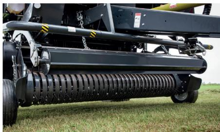
Presse à balles BV5160-BV5200 Kubota avec ramasseur de 86 po et pare-vent à rouleaux.
