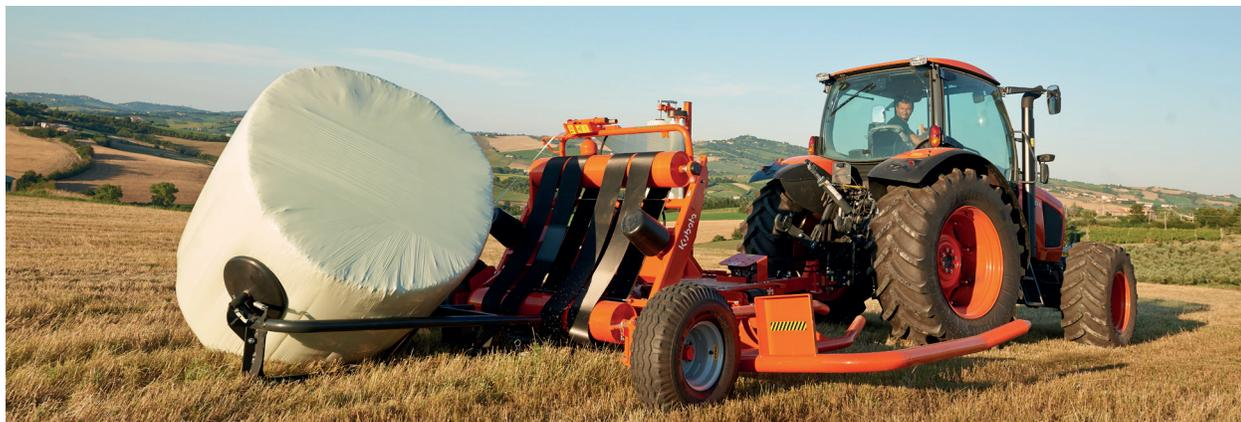
Les enrubanneuses à table tournante Kubota peuvent être équipées d'un retourneur de balles en option.
