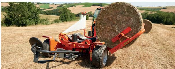
La faible hauteur de levage permet un transfert rapide de la balle du bras à la table tournante.
