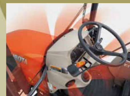
L'air circule à travers le pare-brise pour éviter le gel, le givre et la buée.
