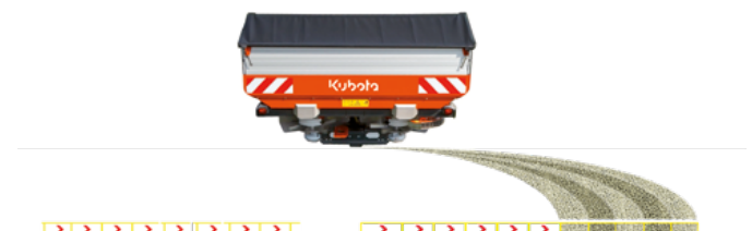
Coupure de sections du centre vers l'extérieur
