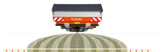
Diminution de la largeur d'épandage de 4m (13'-1") des deux côtés
