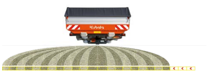
Diminution de 3m (9'-10") de la largeur d'épandage sur la droite
