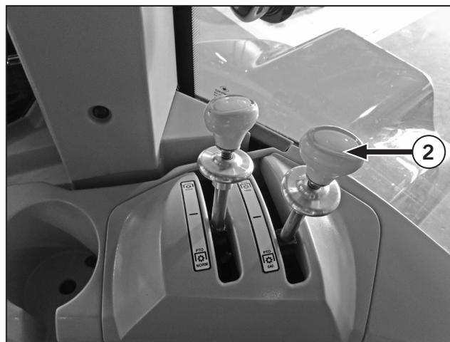
4. Si la prise de force est activée et que le levier d'arbre 1 000 est sélectionné mais que l'arbre 540 est monté. Le capteur de détection d'arbre détecte une surrégime et arrête la prise de force lorsque le régime atteint plus de 650 tr/min.
