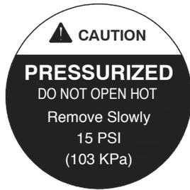
**Avertissement de pression :** Ne retirez pas le bouchon du radiateur lorsque le radiateur est chaud et sous pression. Laissez toujours le moteur refroidir avant de procéder à l'entretien. Pour retirer le bouchon du radiateur, portez toujours des gants et une protection oculaire. Tournez lentement le capuchon jusqu'au premier arrêt et laissez la pression s'échapper avant de retirer complètement le capuchon.
