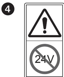
**Avertissement d'amplification de la batterie :** N'amplifiez pas les batteries avec 24 volts. Les composants électriques peuvent être endommagés.
