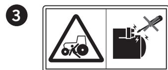
**Avertissement du démarrage du moteur :** Ne pas contourner l'interrupteur de sécurité du démarreur. Le tracteur peut se déplacer brusquement et provoquer des blessures graves.
