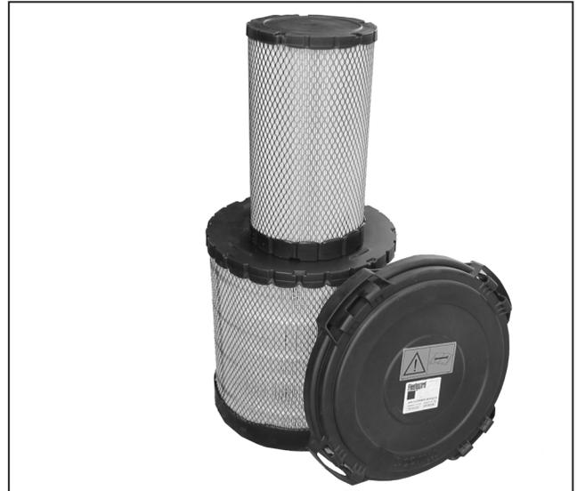
Le filtre à air du moteur comprend 1 filtre primaire et 1 filtre de sécurité. Le filtre à air du moteur est situé dans la partie supérieure du moteur. Le boîtier du filtre à air du moteur est monté sur le cadre supérieur dans le compartiment moteur et les éléments filtrants se trouvent à l'intérieur du boîtier du filtre à air.
