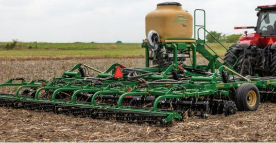
Combinez les avantages de l'application de cultures de couverture et de la gestion du sol avec l'outil Turbo-Seeder PLUS TS9105 de Great Plains! Ces équipements montés sont conçus pour mesurer avec précision les cultures de couverture ou les engrais à l'aide de tarières moulées par injection de haute qualité.
