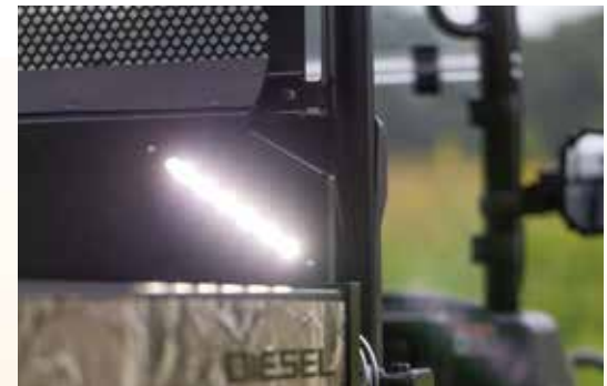
Panneau de chargement avec lampe à DEL
