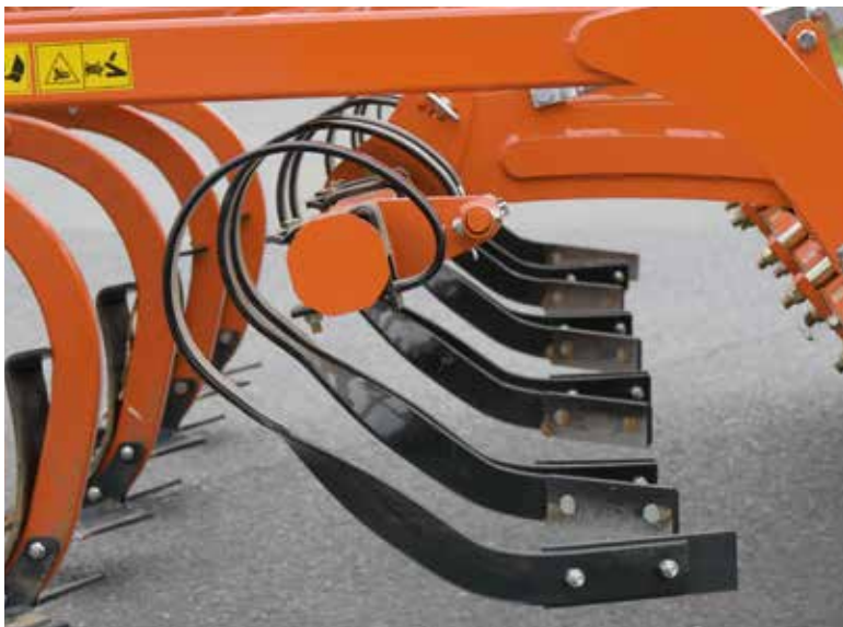
Dents de nivellement pour les sols légers à moyens.
