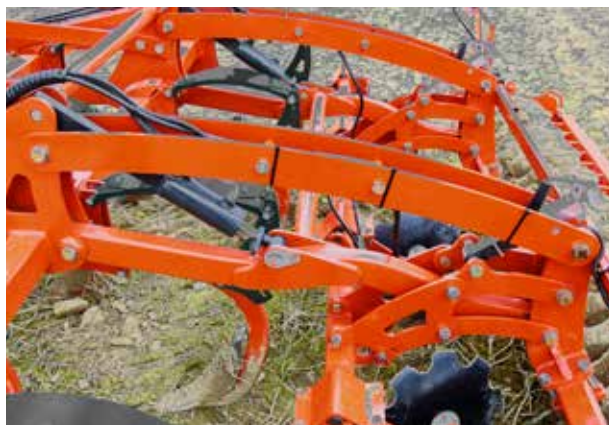
Sur la version Pro : CU3001P, le réglage de la profondeur de travail est encore plus facilité et offre une liaison par double parallélogramme. Ceci permet d'ajuster depuis le poste de conduite la profondeur de travail sans perturber le réglage de l'équipement de nivellement.
