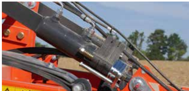
Réglage de la profondeur du CU3001 avec vérins hydrauliques plus des cales pivotantes.
