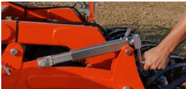
Bon accès et un réglage central de l'équipement de nivellement par manivelle.
