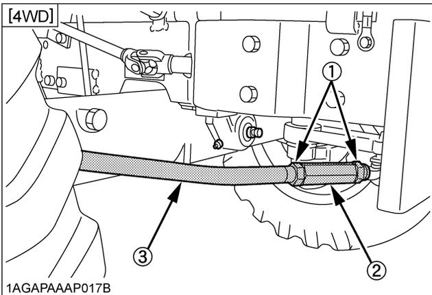
(1) Lock nuts (2) Turnbuckle (3) Tie rod
