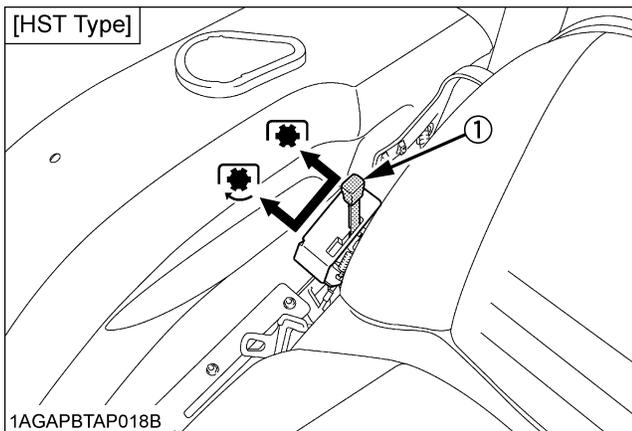
(1) PTO gear shift lever      "ON"
