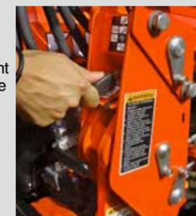
Désengagez le mécanisme de connexion à verrouillage automatique.
