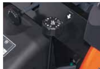
Cadran de réglage de hauteur de coupe
