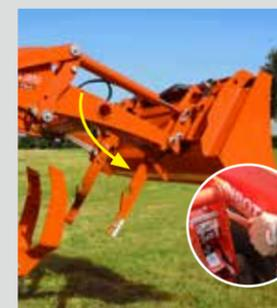
Abaissez le support du chargeur frontal en tirant sur le levier de dégagement du support.
