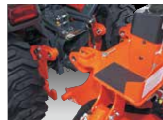
Système d'attache rapide à 4 pts.
