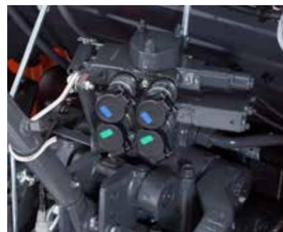
**Valve de commande auxiliaire**
