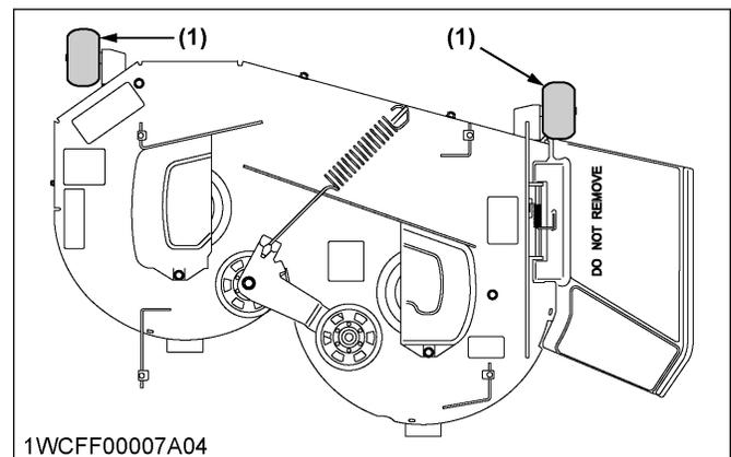
(1) Rouleau anti-arrachement (avant, type à changement de boulon)
