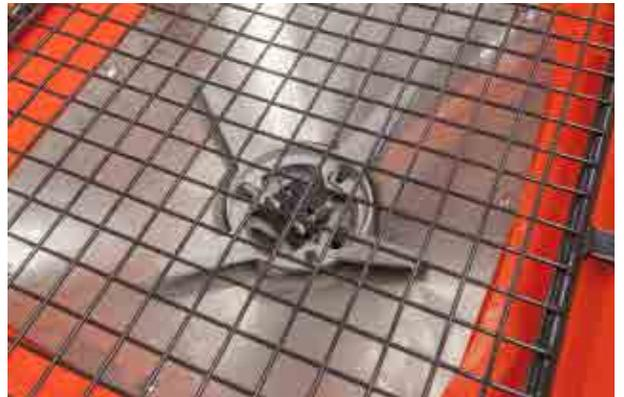
Renfort de trémie en acier inoxydable avec agitateur (Optionnel)
