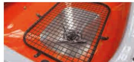
Agitateur avec grille de protection et insert en acier inoxydable
