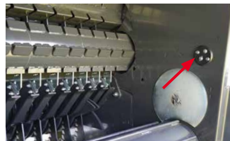
Capteurs d'humidité situés à l'intérieur de la chambre de pressage.
