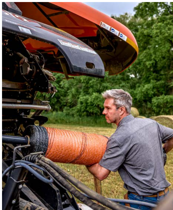
Le stockage ingénieux des rouleaux de fillet permet un chargement horizontal confortable.
