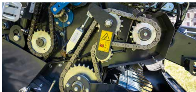
Chaîne de transmission du rotor de 1 1/4".
