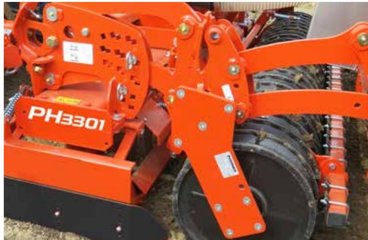
L'attelage EURO permet de dételer rapidement la barre de semis pour une utilisation en solo de la herse rotative.
