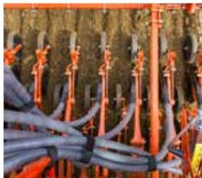
La barre de semis CX-II Kubota se compose de deux rangées de disques Ø325mm (Ø12 13/16") espacées de 12.5cm (5"). Le contrôle de la profondeur est assuré par les roues plombeuses Ø250mm (9 13/16").
