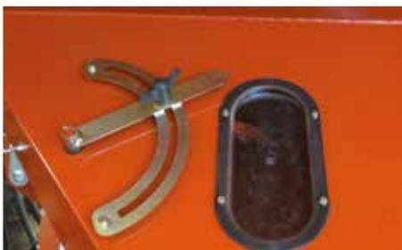
Le capteur de fond de trémie, ajustable sur le côté du semoir, fonctionne en colza comme avec des grosses graines type féverole.
