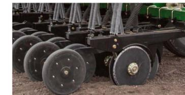
Les options de disque ouvreur de série incluent la **série 00** pour les opérations de travail du sol minimum (illustré), la **série 10** pour le travail du sol minimum avec tringlerie parallèle et la **série 20** pour les semis dans des environnements de sol rappuyé.
