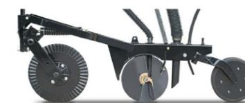
Les disques ouvreurs de la série 06 coupent les résidus à l'aide d'un couteau intégré, tout en préparant un petit lit de semence pour le double disque ouvreur.
