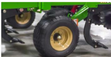
**Les essieux tandem flottants** maintiennent une hauteur constante du châssis principal pour une profondeur de travail du sol précise et uniforme.
