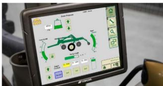
L'une des caractéristiques les plus uniques du modèle Turbo-Max original était sa capacité à **incliner les rangées de disques** de 0° à 6°. Cette caractéristique populaire est également la clé du nouveau VT1100 Turbo-Max.
