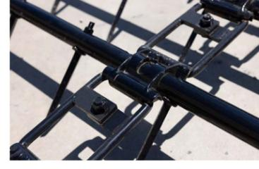
Les herse flexibles sont disponibles sur commande avec huit rangées ou 16 rangées de dents. Chaque section de quatre barres peut être ajoutée ou retirée pour plus de flexibilité. Espacées de 9 po, les dents des nouveaux modèles CT8300 sont 1,5 po (25 %) plus longues que les modèles concurrents, ce qui augmente la durée de vie et améliore le flux des résidus.
