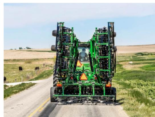
Idéal pour la circulation dense et les ponts étroits, le HT1110 Terra-Max de 20 pi et 25 pi offre un travail du sol à intensité variable et se replie jusqu'à moins de 12 pieds. C'est la solution parfaite pour le transport dans des espaces étroits et les petits travaux!
