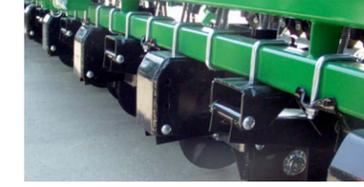
Une **configuration pour culture sur buttes d'irrigation** est proposée pour lever ou abaisser les disques ouvreurs en fonction des pics et des vallées des boutons surélevés.
