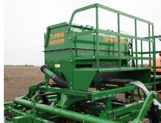
**TURBO-SEEDER™** Travaillez le sol, traitez les résidus et semez des cultures de couverture en un seul passage! Le Turbo-Seeder est un accessoire complet et facile à installer pour toutes les tailles de VT1100 Turbo-Max®, HT1100 Terra-Max et les modèles Turbo-Max de 12 pi à 15 pi. Il s'agit d'une méthode rentable pour le semis en plein de cultures de couverture et de petites céréales.
