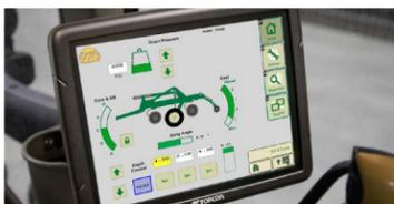
Maintenant offert avec **Implement Command!** Cette option permet à l'opérateur de régler, ajuster et surveiller en cours de déplacement et en temps réel depuis la cabine du tracteur.
