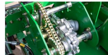
Le nouveau système d'entraînement hydraulique DrillCommand ajoute le contrôle des sections et des taux, et il est compatible avec les autres contrôleurs ISOBUS. Cet entraînement hydraulique efficace nécessite un maximum de 1 gallon de liquide hydraulique par minute pour chaque moteur.
