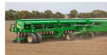
Le châssis et les trémies de semoir révisés présentent une durabilité de premier plan dans l'industrie. La conception de la trémie de semoir permet de la remplir complètement sans déplacer la semence à la main.
