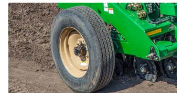
Les grandes roues d'extrémité assurent un excellent entraînement au sol des doseurs de graines, tandis que les moyeux à verrouillage protègent les composants d'entraînement de l'usure.
