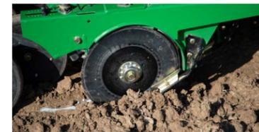
Les lames de disques sont décalées, avec des bords d'attaque alternés pour améliorer la stabilité et réduire le décalage latéral pour une plus grande précision.
