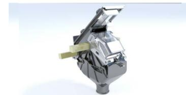
Le nouveau système de dosage s'adapte aux différents taux de semis en modifiant la vitesse du doseur. On peut doser les grosses graines, les petites graines et les engrais à l'aide du même godet.
