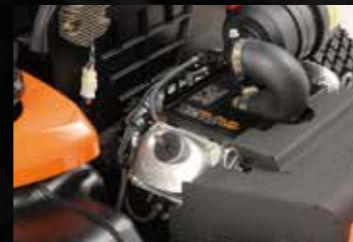
Robinet de purge du carburateur * * Lors de son utilisation, consultez le manuel de l'utilisateur et procédez avec soin.
