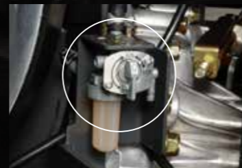
Robinet de purge du carburateur * * Lors de son utilisation, consultez le manuel de l'utilisateur et procédez avec soin.
