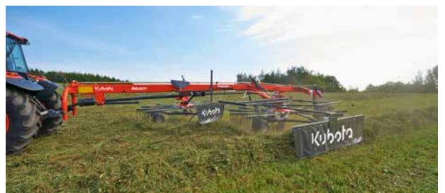
La position inclinée vers le bas du châssis principal du porteur arrière assure une excellente stabilité.
