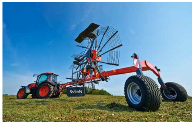
La direction active des roues améliore la maniabilité et les roues surdimensionnées réduisent le compactage.
