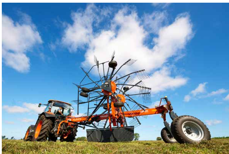
Le Kubota RA2584 se convertit hydrauliquement en position de transport depuis la cabine du tracteur.
