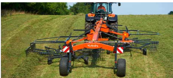
Le concept d'acheminement latéral permet de ramasser la récolte sur 49 pi 2 po (15,00 m) et de créer un seul andain.
