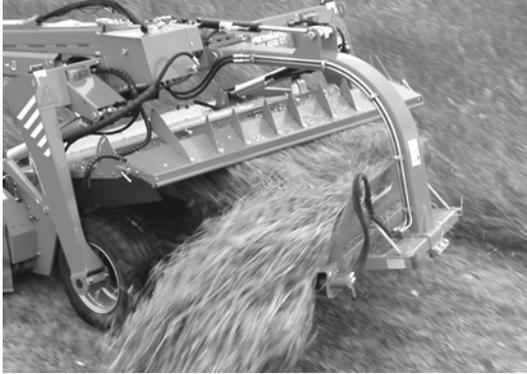
Avec cet équipement, deux andains peuvent être mis ensemble en un seul andain. Cela permet d'économiser le temps et augmente la capacité pour le traitement ultérieur de la récolte. La souplesse de cet équipement offre également la possibilité à l'utilisateur de basculer entre la récolte avec ou sans jumelage des andains sans délai de changement.
