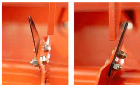
Un système breveté - les couteaux passent le peigne fixe d'un côté ou de l'autre pour une coupe plus uniforme.
