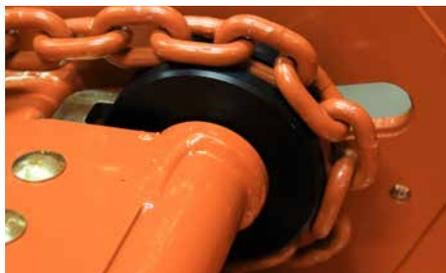
Des rouleaux robustes et résistants à l'usure (PA6) garantissent la longévité et la fiabilité de l'entraînement du convoyeur.
