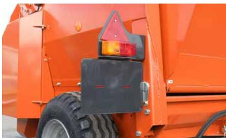
Les modèles Kubota BC1300 PRO et BC1600 PRO peuvent être équipés d'un ensemble d'éclairage bien protégé contre les dommages.
