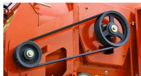
Entraînement par courroie trapézoïdale - peu d'entretien et entraînement silencieux du tambour.
