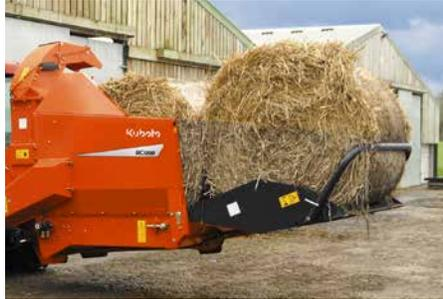
La conception spéciale de la porte et le dispositif de retenue des balles (en option) permettent de transporter une balle ronde supplémentaire.
