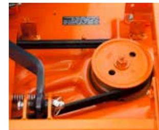
*Le système d'entraînement à courroies multiple en V utilisé sur les tondeuses à éjection latérale de 48", 54" et 60" procure une durabilité d'opération sans égale.*
