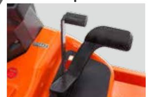
*Par l'opération d'une unique pédale et d'un contrôle de croisière intégré, la transmission hydrostatique (HST) fait de la tonte un travail simple et aisé.*
