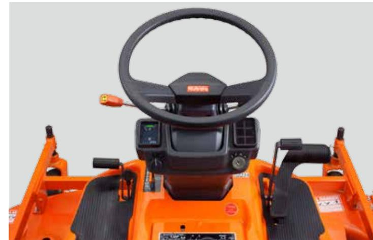
bord vous indique le préchauffage, la charge de la batterie, la pression d'huile et le niveau de carburant. L'inclinaison du volant de direction vous laisse choisir la position la plus confortable durant le travail. La plate-forme semi-plate procure plus de place pour les jambes et rend l'accès sur le tracteur plus facile. L'entretien de la batterie et du grillage du radiateur est aisé.
