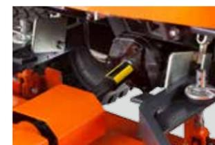
*La prise de force à entraînement par arbre donne plus de puissance de coupe à la tondeuse et moins de problèmes que le système à entraînement avec courroies.*
