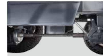
*La conception innovatrice de l'entraînement de l'essieu arrière par arbre horizontal réduit l'usure et améliore la durabilité. Elle permet aussi un transfert de puissance optimum aux roues arrière pendant l'utilisation en fonction 4RM.*
