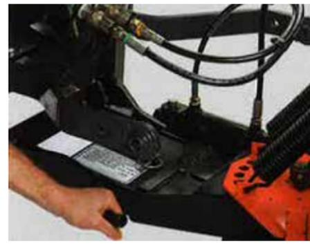
Changez de la souffeuse à neige à la lame ou le balai aisément avec le système unique d'attache-rapide Kubota. (aucun outil nécessaire)
